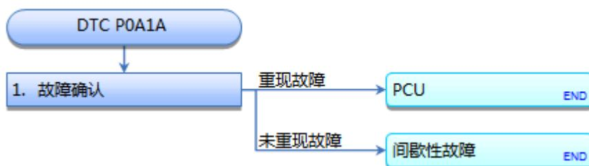
**DTC P0A1A:** 发电机电机控制单元内部电路故障注意: 进行故障排除前, [查看一般故障排除信息](#)。
